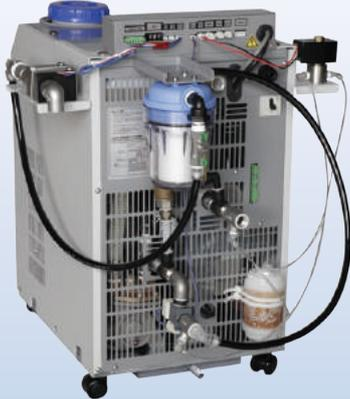
発振器または光学系の仕様に合わせた流量・圧力に調整可能。レーザーヘッドへの異物付着を防止するフィルタの選択、冷水純度の維持が可能。
