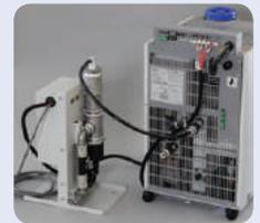
水温立ち上げ用別置ヒータ。制御用としても使用可能。
