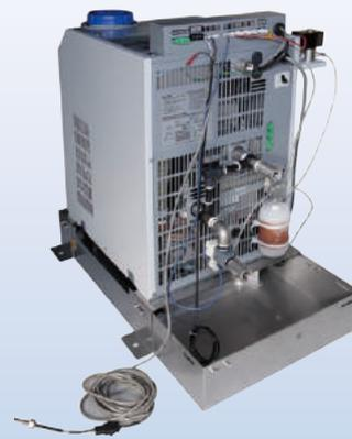
冷水純度の維持管理。万が一の水漏れに備えたフロートスイッチ付きのドレンパンを装備。アルミ回路に対応した脱銅イオン仕様はメーカーオプションで対応。
